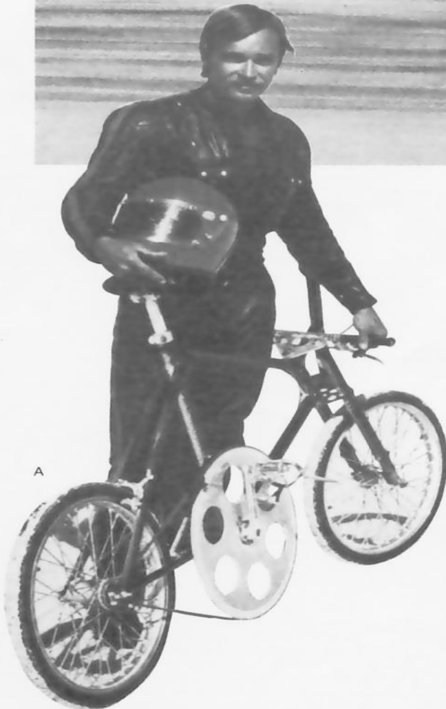
Figure 3. La résistance de l'air est la force principale que le cycliste doit vaincre. Sans elle, puisqu'abrité derrière une voiture de course munie d'un pare-vent, A. Abbott a roulé à 225 km/h avec ce vélo muni d'un plateau avant de 222 dents (A). Conçu pour des sprints le Ontario Motor Speedway (B) a roulé à plus de 85 km/h. Le vélo profilé conçu par Porsche (C) est sans doute trop sensible au vent latéral pour être utilisable sur route, mais le nouveau vélo profilé conçu par Gitane (D) permet, paraît-il, à Bernard Hinault et ses coéquipiers d'économiser 70 watts de puissance à 50 km/h. Ses tubes sont de section allongée, les câbles de freins et leurs patins sont cachés, la forme des pédales simplifiée. (A et B, clichés L'officiel, le cycle , C cliché Revue du cycle , D cliché Gitane).
